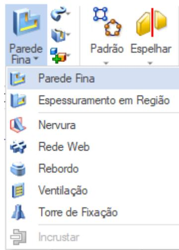
Digite o valor **10** no campo **Espessura Comum**(Barra de Fita) e tecle **Enter**. Clique sobre a face inferior do bloco e tecle **Enter**
