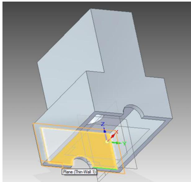
**12.** Crie uma extrusão de **20mm** (altura) e **10mm** de largura a partir do plano indicado na figura:
