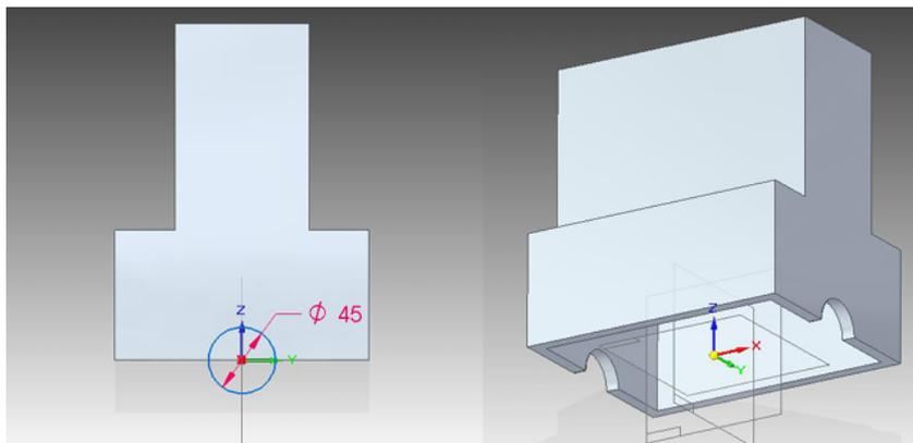
**10.** Faça outro recorte através de toda a peça, agora a partir da face superior do bloco com o perfil indicado na figura:
