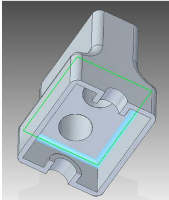
21. Para finalizar a peça faça um arredondamento de 5 mm nas arestas indicadas na figura.
