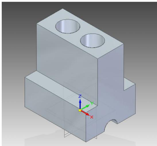
17. Faça arredondamentos com raio **40 mm** nas duas arestas indicadas na figura:
