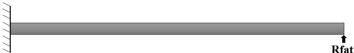
Figura 47: Diagrama de corpo livre usado na análise de tração e compressão devido ao momento fletor no braço de suporte inferior da célula de carga.
