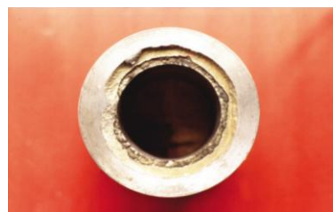
Figura 2.6 – Corrosão por Fresta Fonte: CASTRO
