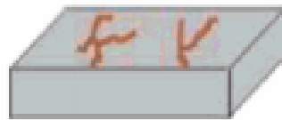
Figura 2.5 – Corrosão Filiforme Fonte: ABRACO (2006)
