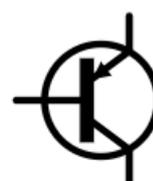
Figura 47: Simbologia do transistor PNP
