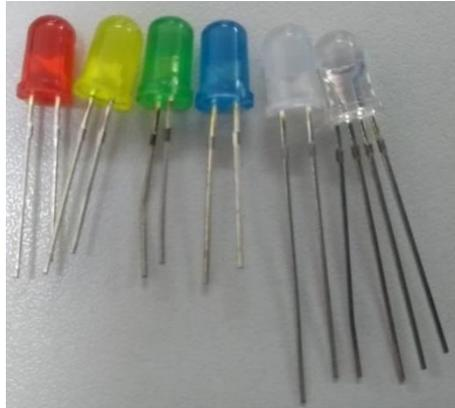
Figura 25: LEDs coloridos e LED RGB (na extremidade direita)
