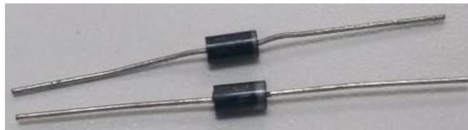
Figura 23: Diodos
