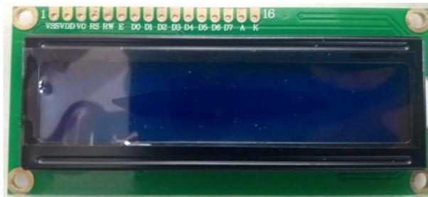
Figura 30: Display de cristal líquido (LCD)
