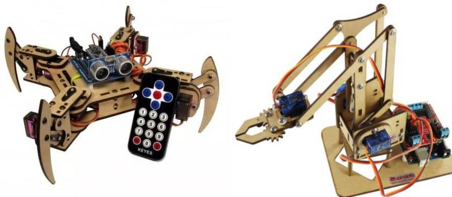
Figura 2: Aranha e braço robóticos com uso do Arduino
