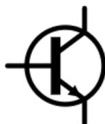
Figura 46: Simbologia do transistor NPN
